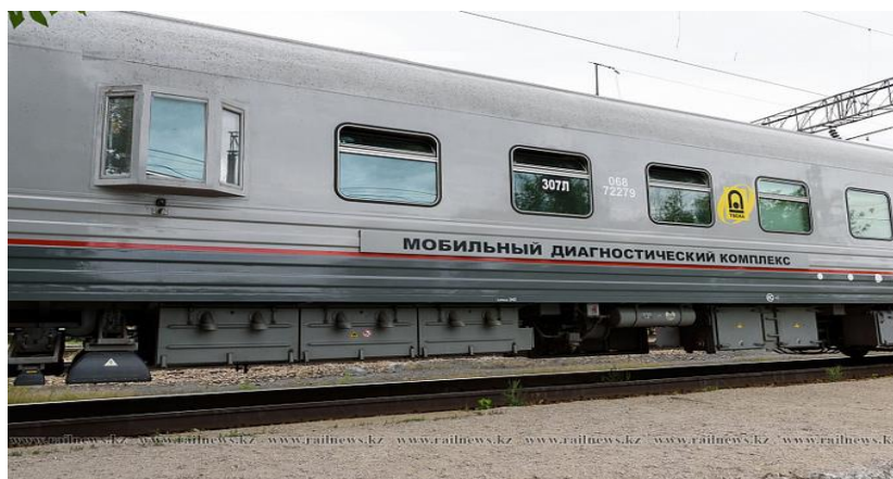
Рисунок 2 - Путеизмерительный дефектоскопный вагон
